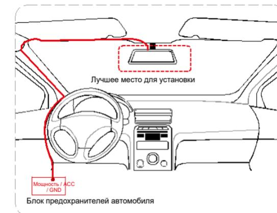
Подключите кабель питания к видеорегистратору 4G Cloud Dash Camera и блоку предохранителей в автомобиле. (**Примечание** в Разница между источником питания и АСС, GND подключен к металлической части автомобиля.)
